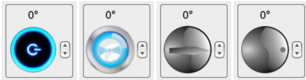
Abbildung 13: Container RoundButton. Sie können die Winkel mit der Kontrolle UpDownArrow, die runde Taste mit der Maus oder durch Anklicken der Schaltfläche. Der Aspekt der Kontrolle können eingestellt werden und der Benutzer kann eigene Logos erstellen.
